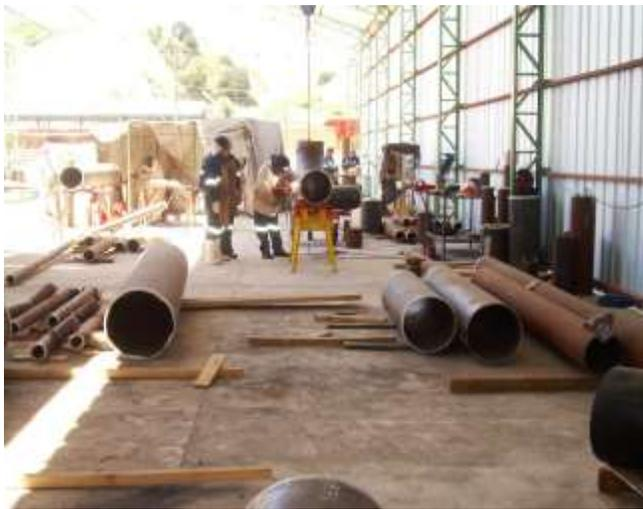
Maquisant para el proyecto que se esta ejecutando en Nacimiento, por la empresa Echeverría Izquierdo. Contrato 721 esta realizando la fabricación del sistema contra incendio, fabricación de spool de cañería en acero carbono.
